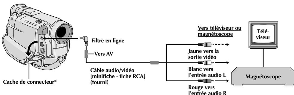
\* Pour raccorder les câbles, ouvrir ce cache.
