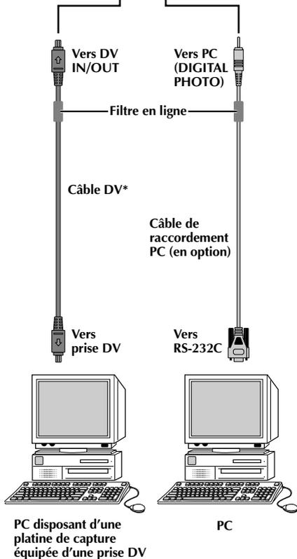
\* Utiliser le câble DV fourni avec la platine de capture.
