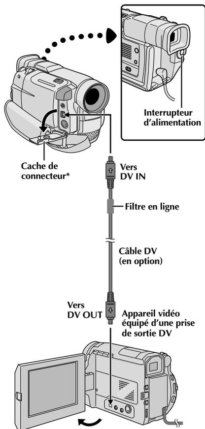
\* Pour raccorder le câble, ouvrir ce cache.
